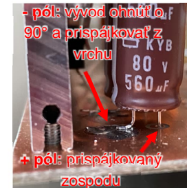
Obr. 5: Pripojenie elektrolytických kondenzátorov
